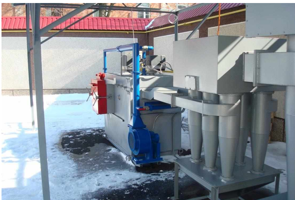
Мал.3.4.2. Приклад установки для спалювання медичних відходів
