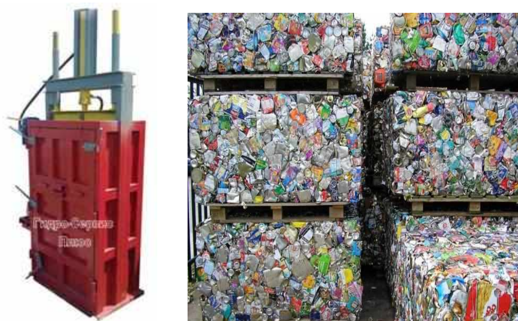
Мал. 3.2.19. Приклади пресу та готової продукції дільниці пресування
