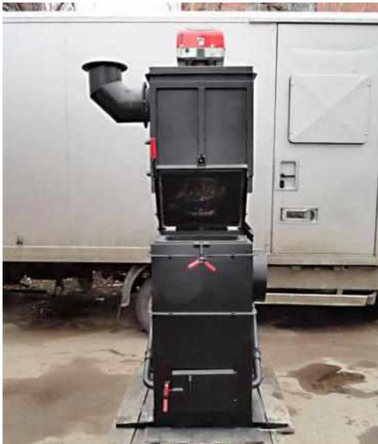
Мал.. 3.4.3. Приклад установки для спалювання медичних відходів УТ-50
