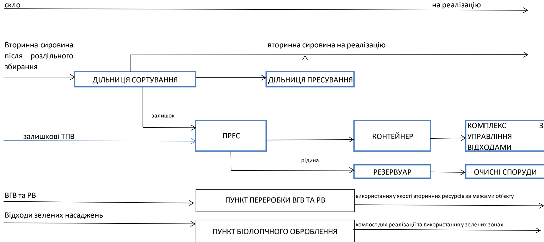
Мал. 3.2.24. Технологічна схема функціонування СП
